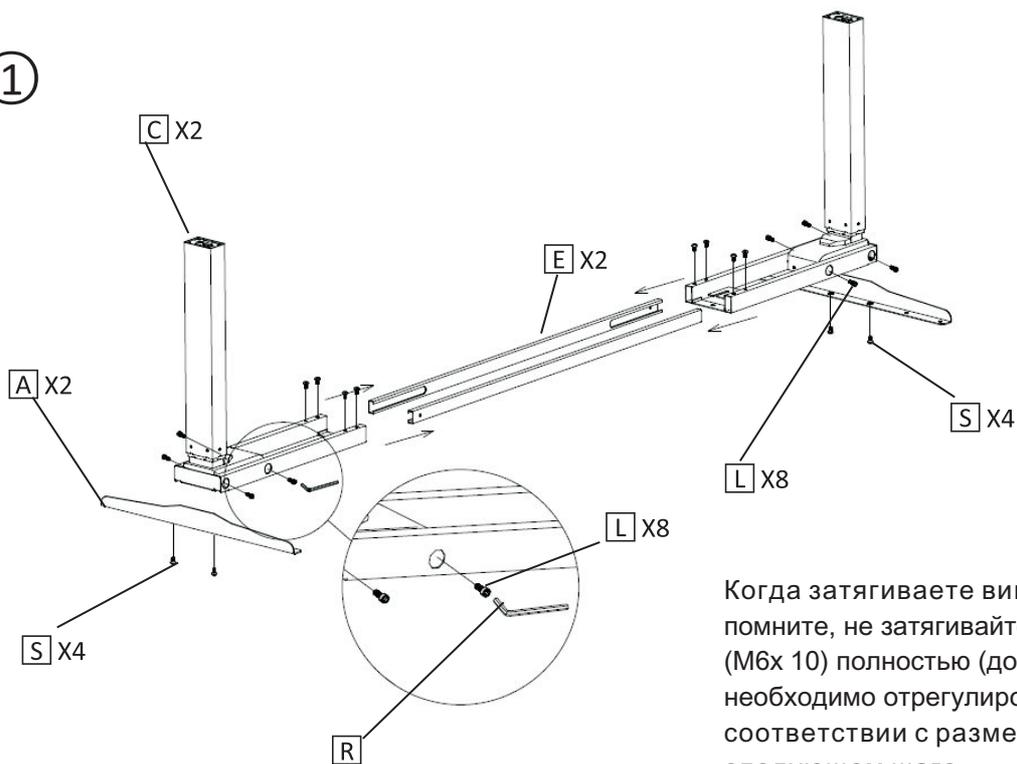
Когда затягиваете винты для рейки [E], помните, не затягивайте 8 винтов (M6x 10) полностью (до конца), потому что необходимо отрегулировать длину в соответствии с размером столешницы на следующем шаге.
