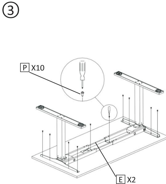
После установки столешницы, когда убедитесь, что соединительная рейка установлена на нужную длину, тогда полностью затяните 8 винтов соединительных стержней, а также затяните винты ST4 10 шт., чтобы закрепить столешницу на основании.
